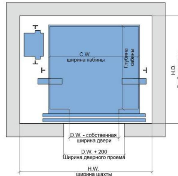
Строительный чертеж лифта GRPN20 без машинного помещения
